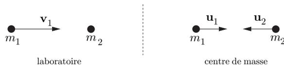
Figure 7.1. Collision unidimensionnelle de deux particules. Dans le référentiel du laboratoire, la particule 2 est au repos avant la collision. À droite, on se place dans le référentiel du centre de masse.
