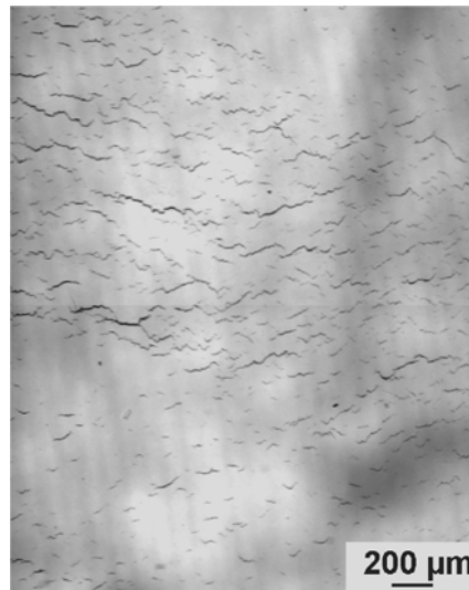
Figure 96 : Réseau de micro-fissures de fatigue à la surface d'une éprouvette lisse de TA6V (800 MPa, R=-1 ) [Le Biavant, 2000].
