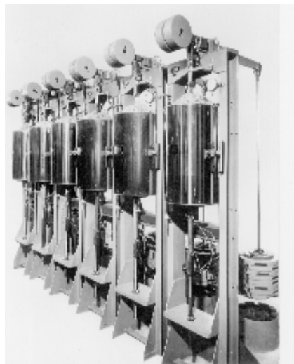
Figure 73 : batterie de machines de fluage.
