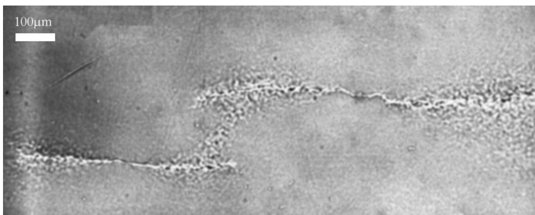
Figure 105 : Deux fissures de fatigue sur le point de coalescer dans l'alliage de Nickel N18 testé à 60 Hz et à température ambiante, l'aspect granuleux autour des fissures provient de la déformation plastique des grains. L'étendue de la zone déformée augmente avec la longueur de la fissure [Pommier, 1992].
